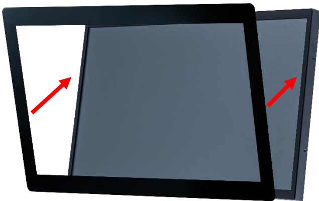
步驟 1: 將前嵌套件與螢幕本體結合 (此工序出廠時已先預組完畢)
