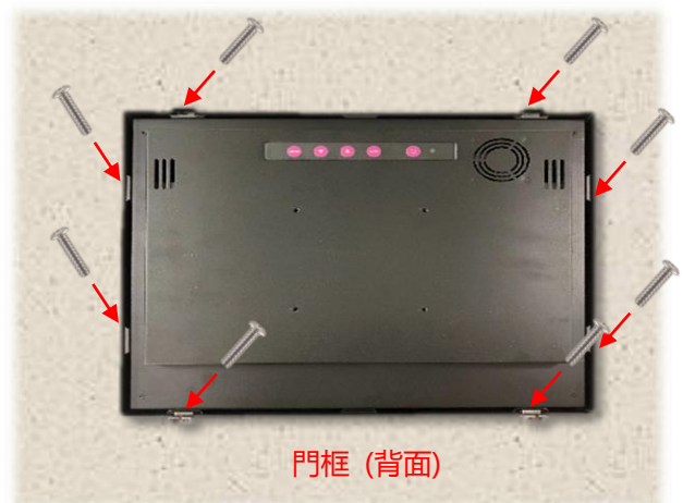
步驟 3: 從背面裝上卡扣後, 以螺絲固定 (視需求或位置限制, 最多可裝 10 個卡扣)
